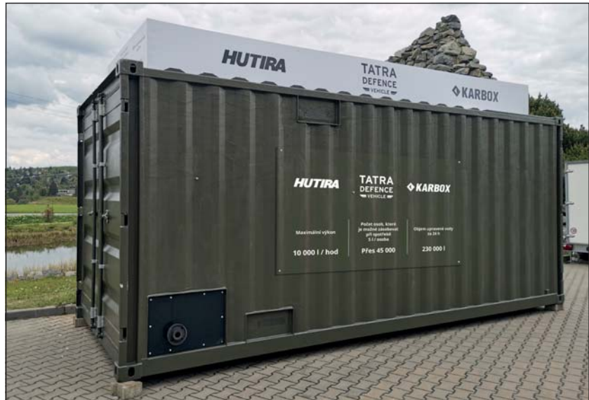
■ Kontejnerová úpravna vody CCW 10 000 dokáže vyčistit až 10 000 litrů surové vody za hodinu, což při kalkulované spotřebě 5 litrů pitné vody na osobu a den stačí pro více než 45 000 lidí.
